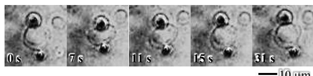
Fig.2 光ピンセットによるベシクルの変形と膜弾性による回復
