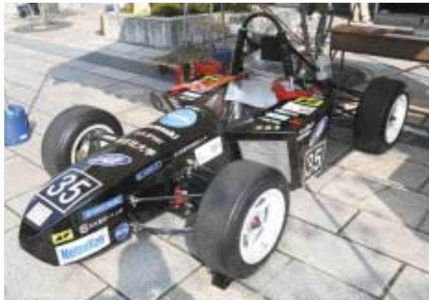
2006年度日本学生フォーミュラ大会出場フォーミュラカー (カウルは竹繊維を用いたFRPにより製作されている。)
