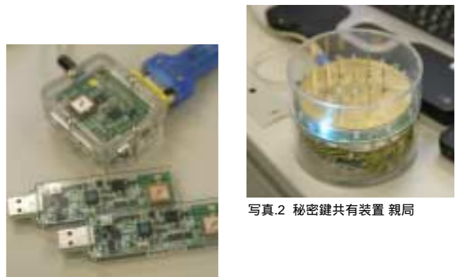
写真.1 秘密鍵共有装置 子局 写真.2 秘密鍵共有装置 親局
