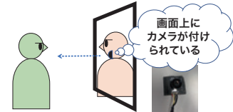
図2. カメラアレイ埋め込み型ディスプレイ(左)と実際に作成したディスプレイ上のカメラの例(右:直径1cm)。
